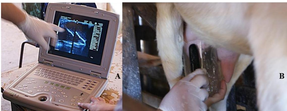
Figura 8. Aparelho ultrassonográfico KX 5000<sup>®</sup> (A); obtenção das imagens via contato indireto da sonda com o teto direito dos animais avaliados (B). Fonte: Arquivo pessoal.
