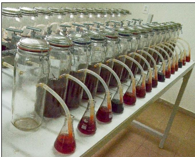
Após a aplicação do fertilizante, os frascos foram mantidos em repouso por mais 2h. Depois desse período, os frascos foram ventilados manualmente e, finalmente fechados para a realização da primeira amostragem. Para a amostragem, os
