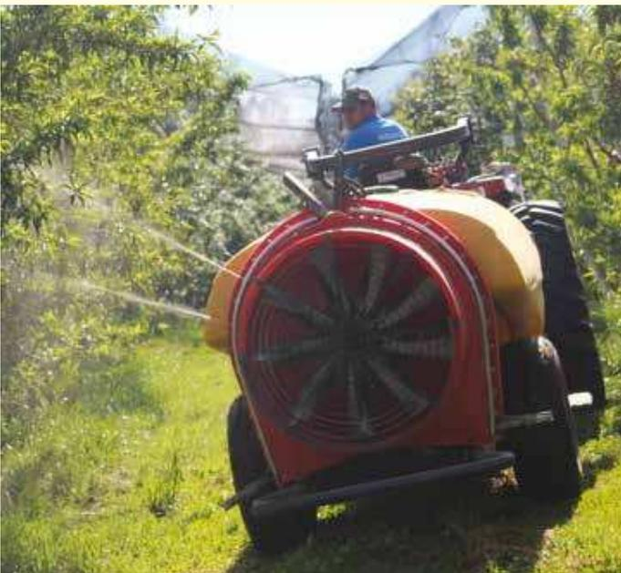
Aplicação de iscas tóxicas com turboatomizador montado em trator
