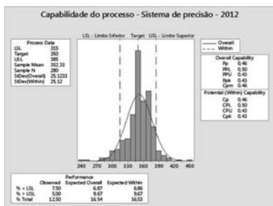
Figura 2. capacidade do processo utilizando o sistema de precisão.
