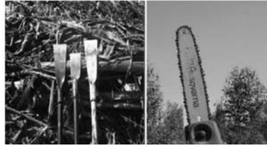
Figura 1. Lado esquerdo, ferramenta especializada (cavadeira de uma folha) para realização da desbrota precoce e do lado direito, motorroçadeira de corrente utilizada na desbrota convencional.
