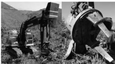
Figura 1. Máquina base (Komatsu PC160) e cabeçote rotree realizando o preparo da cova de plantio (esquerda), detalhe do cabeçote (direita).
