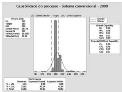
Figura 1. capacidade do processo utilizando o sistema convencional.
