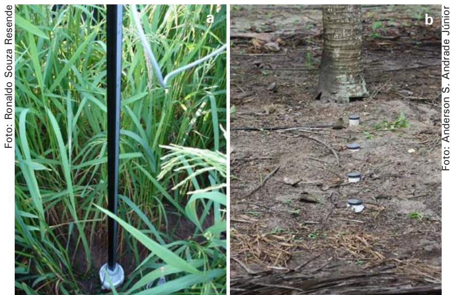
Figura 9. Sonda de capacitância (a) e tubos de acesso (b) instalados em um transecto na zona de coroamento de coqueiro-anão.
