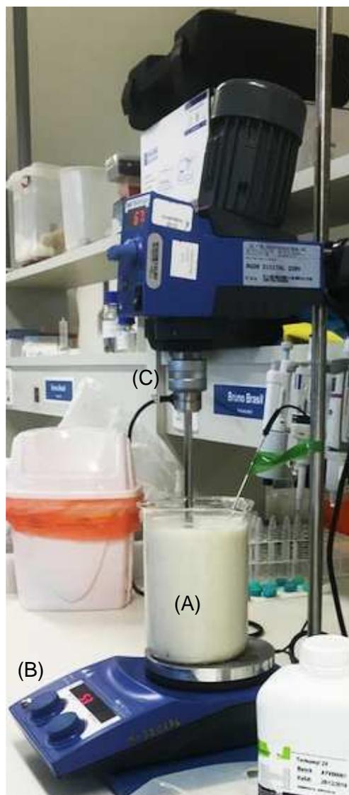
**Figura 8.** Sistema reacional utilizado para as hidrólises enzimáticas do amido presente no arroz comercial e no arroz gigante BRS AG. Onde: (A) béquer com a mistura reacional (arroz previamente moído e tampão citrato de sódio), (B) placa de aquecimento, (C) homogeneizador.
