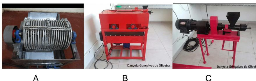
Figura 1 – Equipamentos utilizados para separação das partes constituintes dos frutos da bociuiva (A – protótipo para descascamento e despulpamento. B – protótipo para separação endocarpo da amêndoa. C – Prensa tipo *expeller* para extração óleo da amêndoa.
