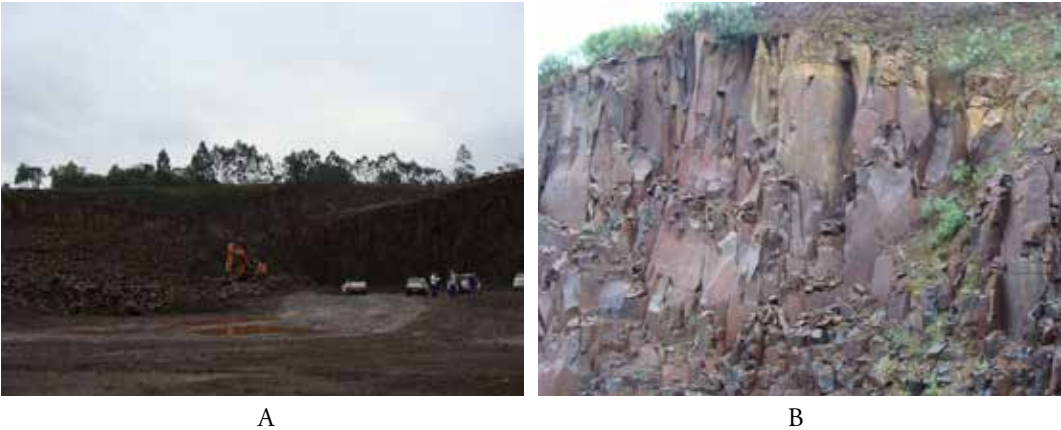
Figura 10 – A: Vista de SE para NW de parte da lavra Construbrás a partir da bancada inferior. B: Aspecto das juntas colunares decimétricas a sub-métricas do derrame lavrado pela Construbrás de Constantina.
