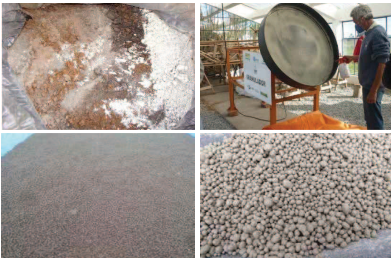
Figura 6 – Ilustração da mistura de diferentes tipos de rochas (blendagem), do granulador artesanal utilizado e de produtos finais peletizados e granulados. Embrapa Clima Temperado, 2016.
