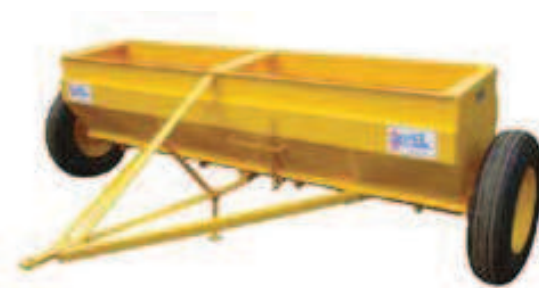
Figura 8 – Formas de aplicação dos remineralizadores: a) distribuição a lanço com discos centrífugos, b) distribuição por gravidade tipo “cocho”; c) semeadora com sulcador, caixas e dosadores para fertilizantes; d) aplicação manual.
