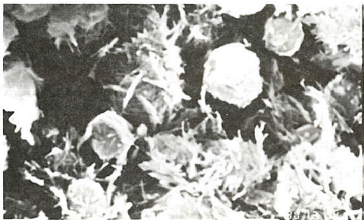
FIGURA 9 - MEV DE POLIEDROS MINERALIZADOS COM ATAPULGITA - AUMENTO 11.000 x
