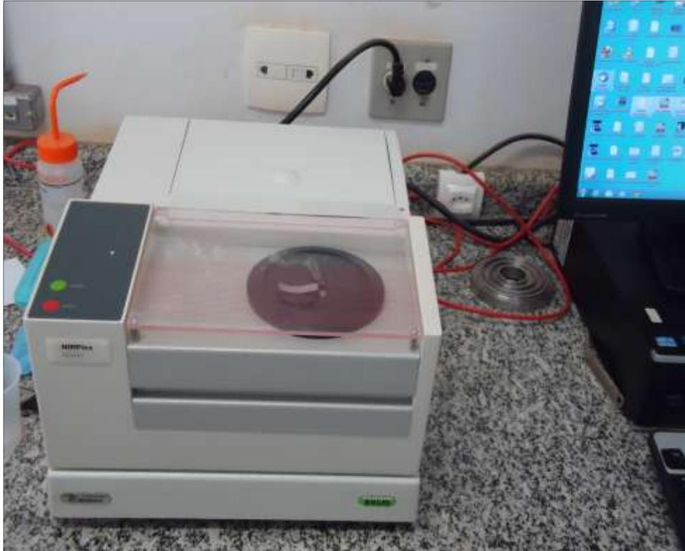
FIGURA 3.2 - Espectrômetro de Infravermelho Próximo utilizados nas análises.
