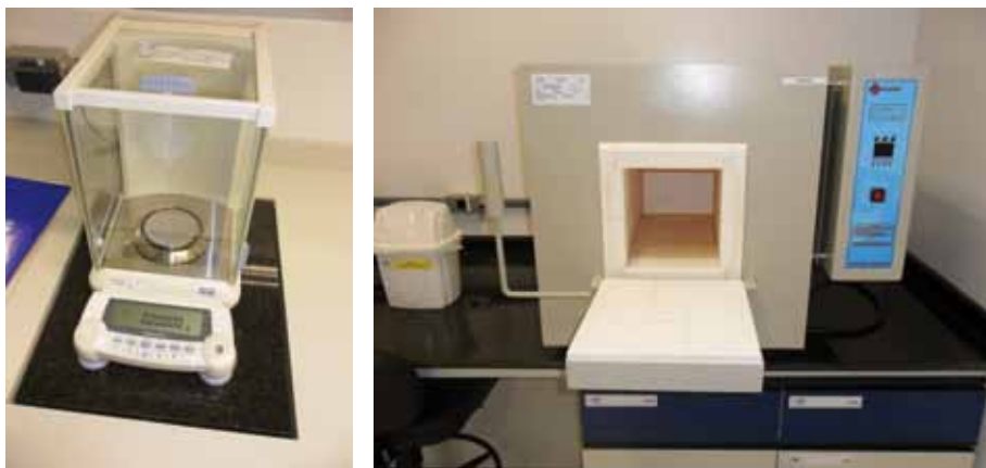
Figura 3. Aparatos para análise gravimétrica. Balança analítica (esquerda) e forno do tipo mufra (direita).
