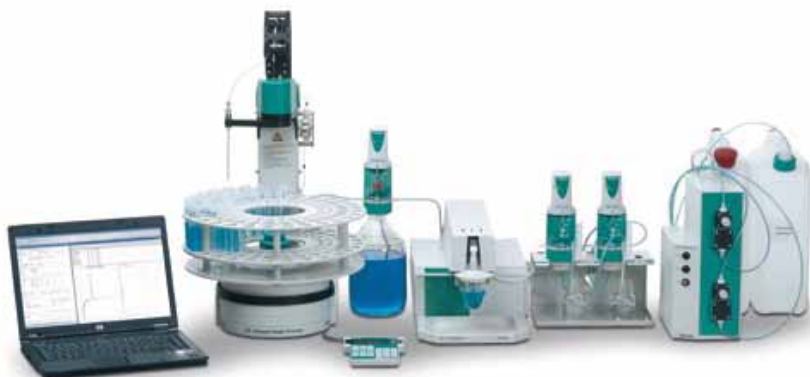
Figura 16. Sistema de voltametria cíclica.
