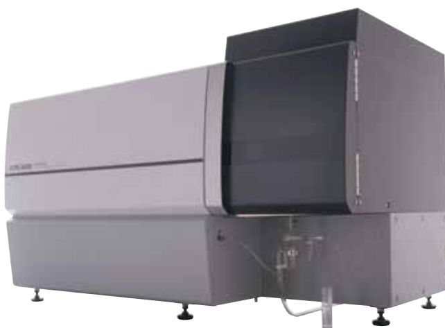
Figura 12. Espectrômetro de emissão ótica com plasma indutivamente acoplado.
