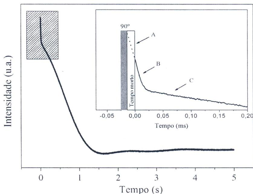
**Figura 12.2** FID de uma semente de amendoim após um pulso de  $90^\circ$  em um espectrômetro de RMN-DT. A expansão do sinal mostra o pulso, o tempo morto do espectrômetro e o início do sinal FID. A linha tracejada (A) mostra o sinal FID durante o tempo morto contendo todos os componentes da semente. O FID em (B) mostra parte do sinal dos componentes sólidos sobreposta ao dos componentes líquidos. O FID em (C) contém somente o sinal dos componentes móveis da semente.
