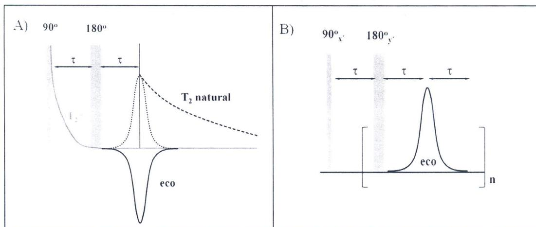
Figura 12.5 (A) Sequência de eco de *spin*  $90^\circ-\tau-180^\circ$ . O eco com linhas contínuas está no modo fase, com deslocamento de  $180^\circ$  em relação ao FID, e o eco com linha pontilhada está no modo magnitude. (B) Sequência de pulsos da técnica de CPMG, em que o pulso de  $180^\circ$  está defasado de  $90^\circ$  em relação ao primeiro pulso<sup>9</sup>.
