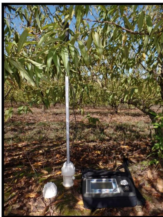
Figura 4: Sonda de capacitância modelo Diviner 2000® e tubo de acessos utilizados para monitorar o conteúdo de água no solo. Fonte: O Autor
