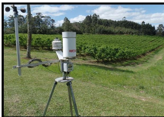
Figura 3: Estação Agrometeorológica Automática Squitter modelo ISIS S1220, utilizada para coleta de dados de chuva, temperatura do ar, umidade relativa do ar, radiação solar e velocidade do vento. Fonte: O Autor.
