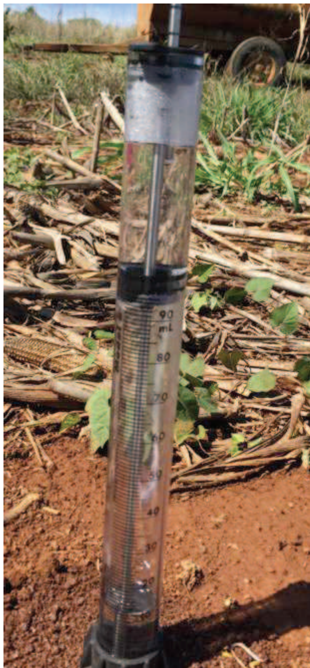
Figura 1. Detalhe do mini infiltrômetro de disco sendo utilizado na área experimental. Fonte: autor.
