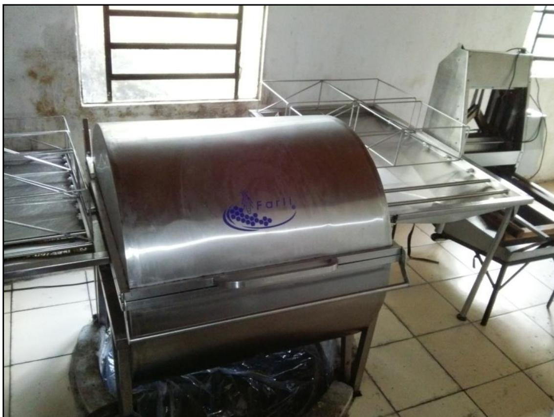
**Figura 27:** Fotografia da casa do mel do apicultor que contém 1500 colmeias, equipado de centrífuga elétrica com capacidade de 69 caixilhos de mel e, ao lado, a fotografia de desoperculadora elétrica com sistema de aquecimento de laminas para melhor eficiência na desoperculação.
