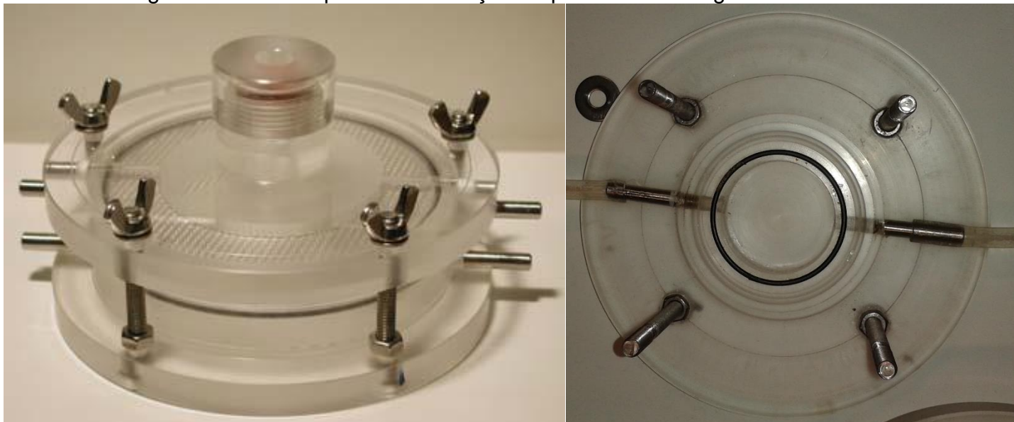
Figura 5 – Câmara para determinação de permeabilidade gasosa em filmes.
