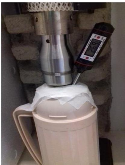
**Figura 1.** Aparato para utilização da haste da sonda de ultrassom e termômetro digital em garrafa térmica para calibração do equipamento.
