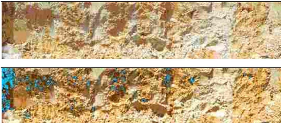
Figura 9 – Imagem do perfil RO-15 2Cgf2 original, acima, e tratada, abaixo, com as regiões quantificadas destacadas em azul.
