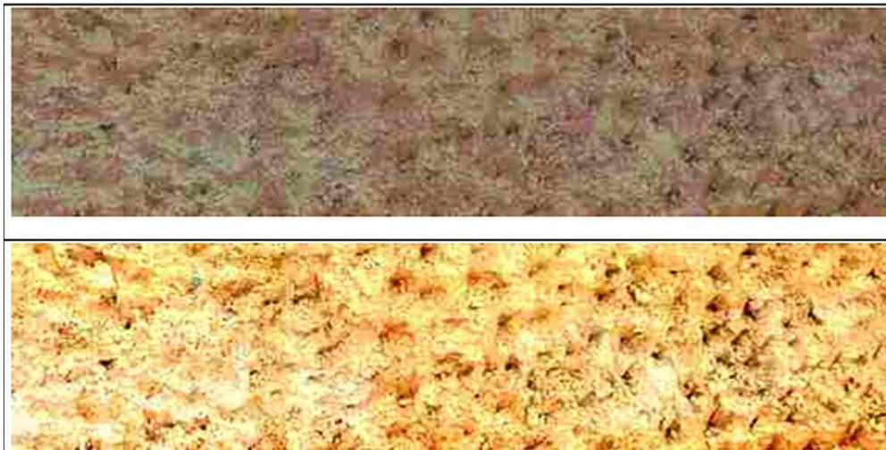
Figura 7 – Imagem do perfil RO-14 B<sub>wgf2</sub> original, acima, e tratada, abaixo, com as regiões quantificadas destacadas em azul.
