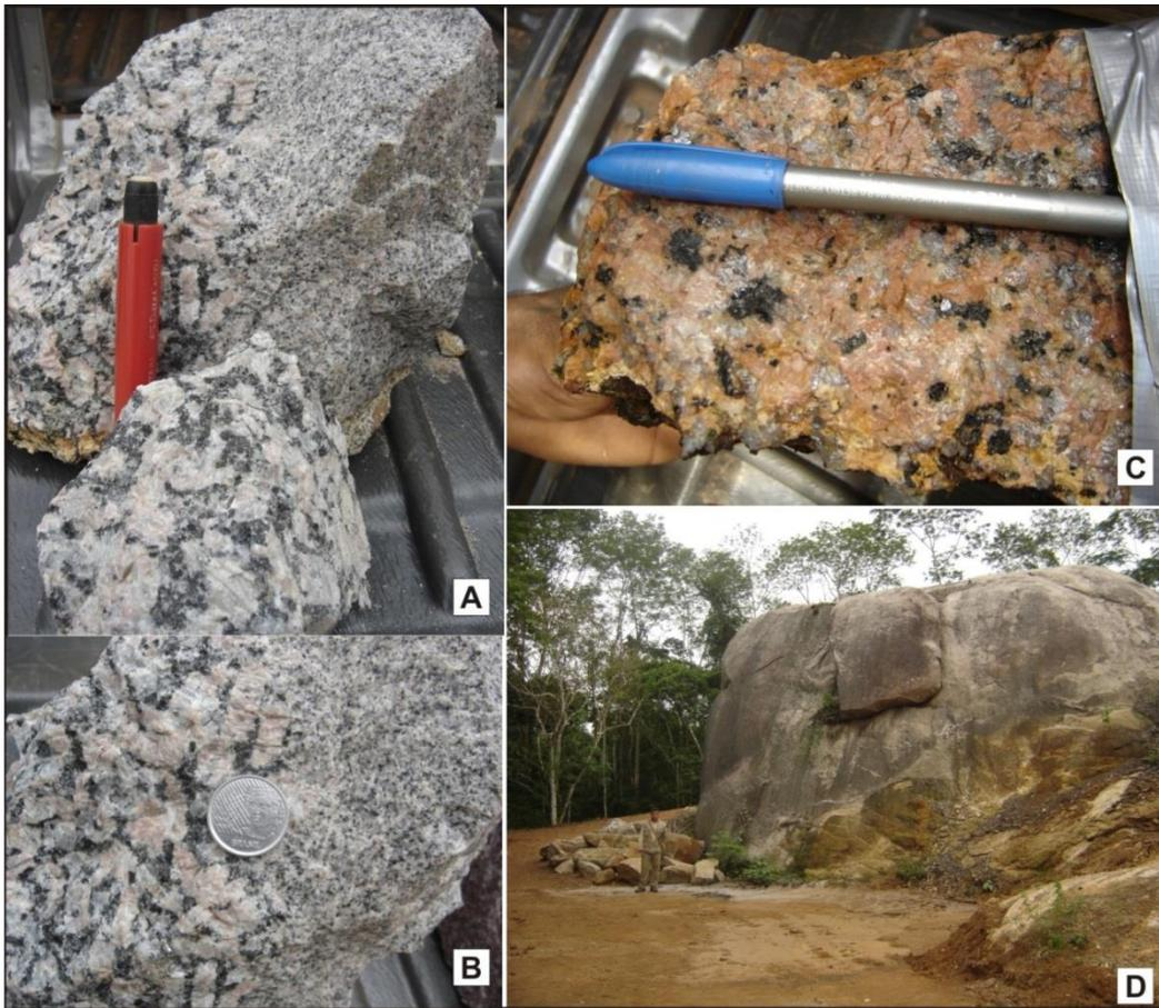
**Figura 4.** Granito da Suíte Intrusiva Santo Antônio - (A) Contato de distintas fácies graníticas; (B) Detalhe do contato (C) Fácies inequigranulares de cor rósea, nas proximidades do balneário cachoeirinha; (D) Área de exploração da pedra GM engenharia (brita).
