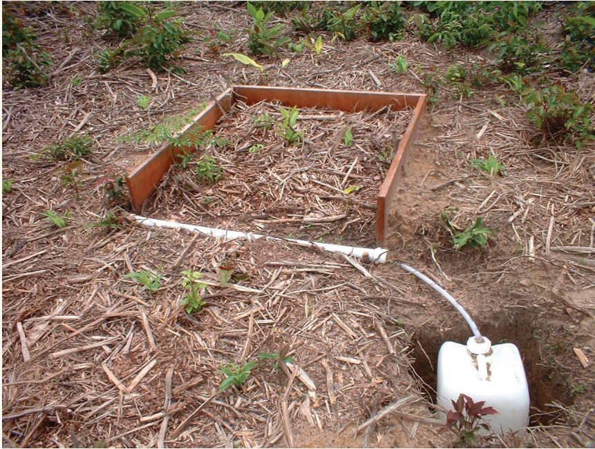
Figura 2 – Esquema de parcela para monitoramento do escoamento superficial e fotografia de parcela em uma área com preparo de área por corte-trituração da vegetação secundária.
