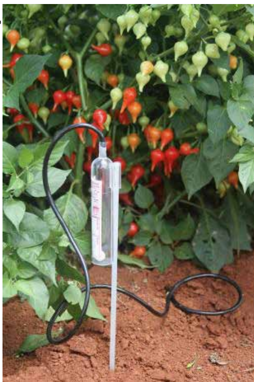
Figura 1. Uso do Irrigas para controle da necessidade de irrigação.
