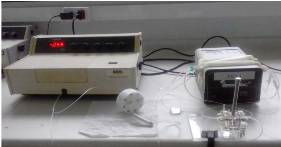
Figura 9: Método de análise por injeção em fluxo (FIA) e o espectrofotômetro
