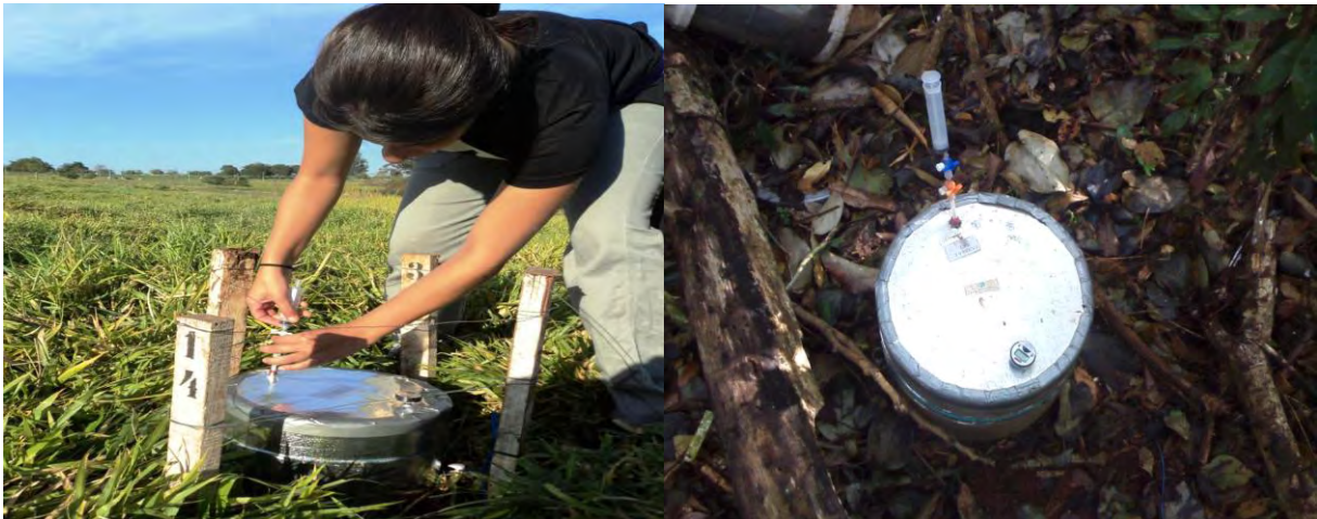
Figura 6. Câmara estática de PVC utilizada na coleta de gases.
