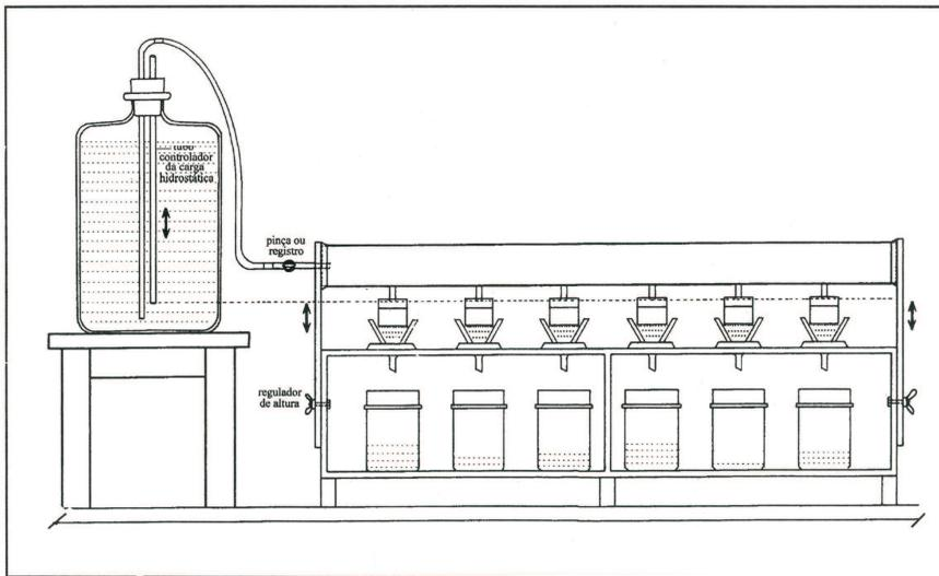
Figura 1. Diagrama do permeâmetro de carga constante.
