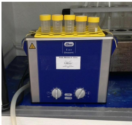
Figura 1. Banho ultrassônico utilizado no processo de decomposição ácida das rochas silicáticas.
