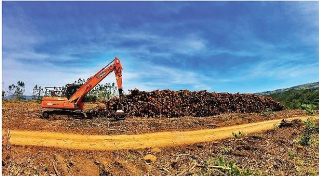
**Figura 1.** Modelo Doosan DX225 adaptado com garra Rotobec avaliado durante o estudo.
