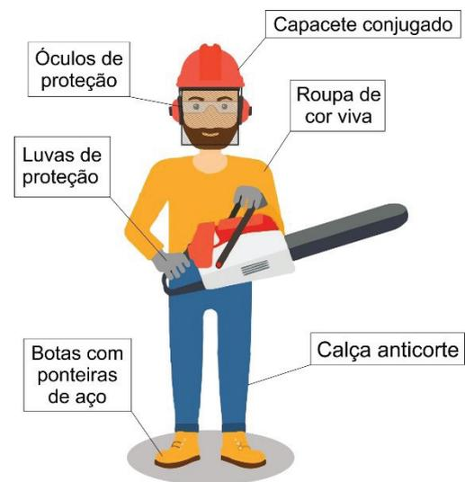
**Figura 1.** EPIs para o operador de motosserra. Fonte: Adaptado de Depositphotos (2017).
