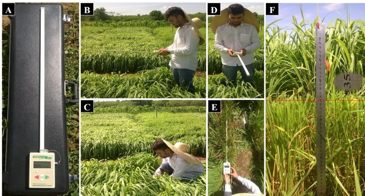
A: analisador PAR/LAI; B e D: Medição na vertical e horizontal sobre o topo do dossel; C e E: Medição na vertical e horizontal na base do dossel; F: medição da altura ideal do dossel de acordo com IAFr preconizado. Fonte: Renato G. Fontinele.
