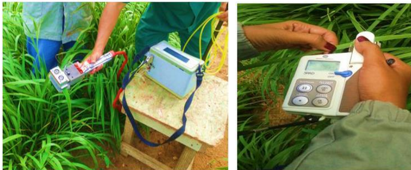
Figura 6 – Aferição das trocas gasosas e avaliação do índice relativo de clorofila na porção mediana da folha. Sobral – CE, 2016.
