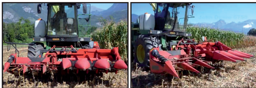
Figura 3. Colhedora de forragem adaptada para colheita de toplage. Fonte: Shinners et al. (2015).
