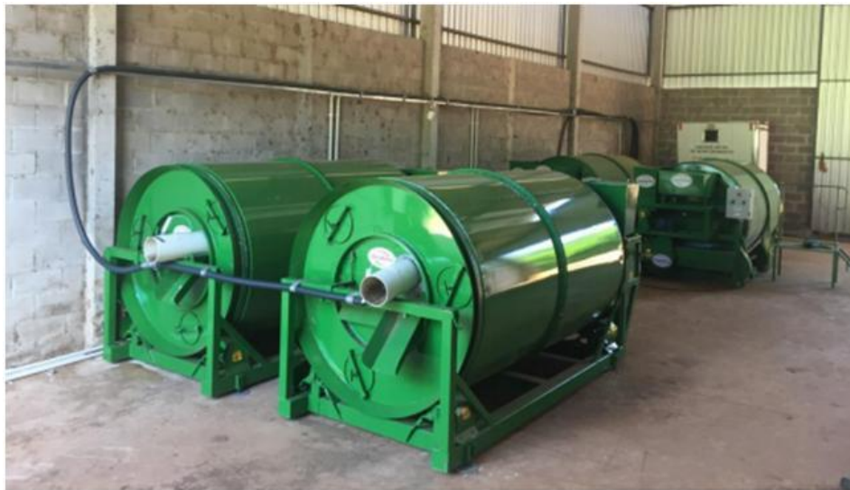
Figura 01: Unidade experimental, com quatro reatores cilindros rotativos e tubulação de coleta de gases.
