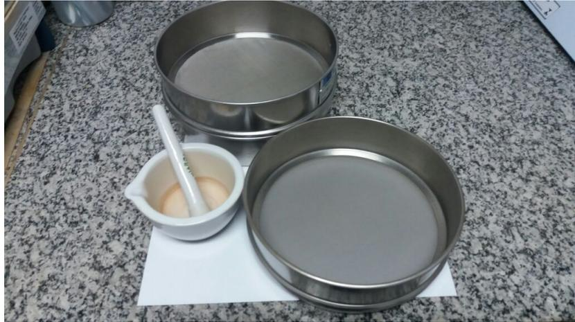
Figura 18 – As pastilhas de solo são elaboradas a partir de solo moído e peneirado. Aqui são mostradas o gral e pistilo usados para triturar a amostra, bem como as peneiras utilizadas.
