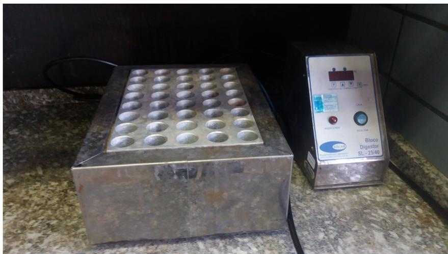
Figura 23 – Bloco de aquecimento, utilizado no processo de decomposição do solo.
