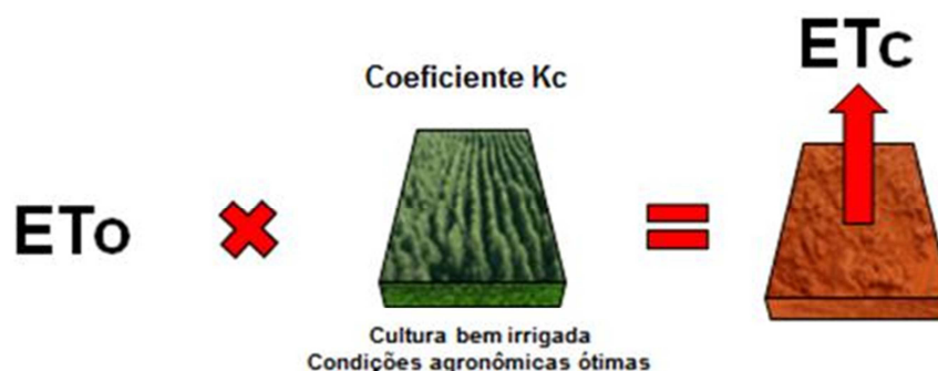
Figura 12 – Esquemático da estimativa da evapotranspiração da cultura ( ET_c ) (Adaptado de Allen et al., 1998).
