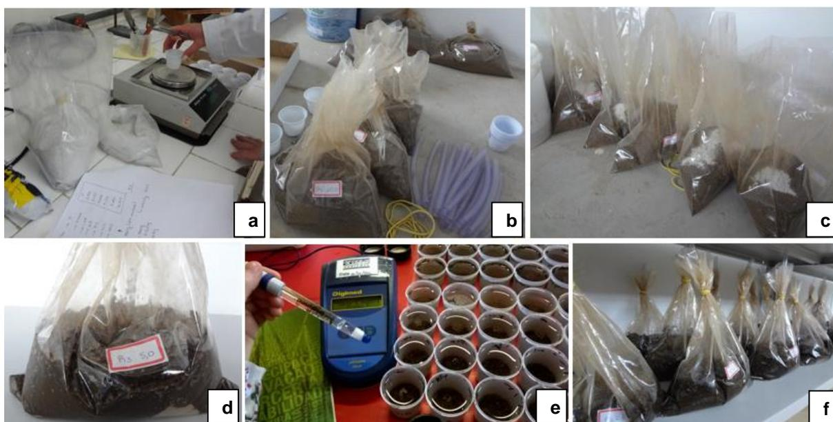
Figura 3 - Teste de incubação para adequação do pH do lodo de esgoto de Passo Fundo: Pesagem das doses de calcário (a); Alocação do lodo nos recipientes (b); Doses de calcário juntamente ao lodo (c); Lodo de esgoto/Passo Fundo + calcário + água (d); Determinação do pH (e); Alocação das unidades experimentais (f).
