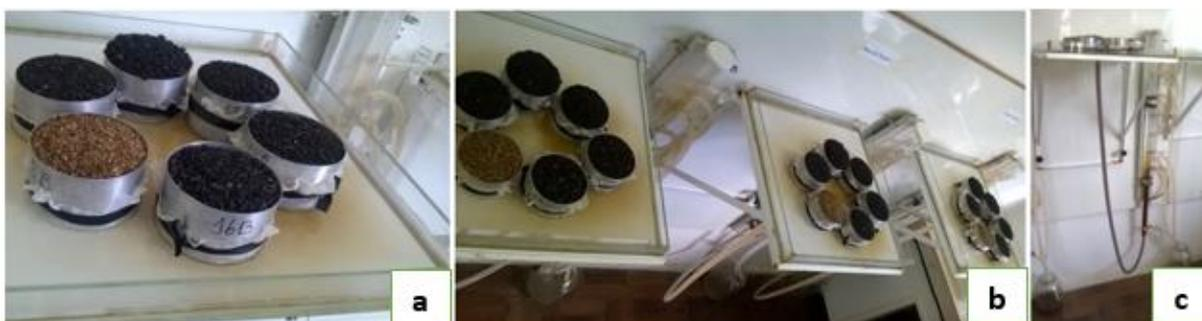
Figura 5 - Cilindros alocados em mesa de tensão (a), conjunto de amostras sobre mesas de tensão em triplicata (b), sistema de vasos comunicantes da mesa de tensão (c).
