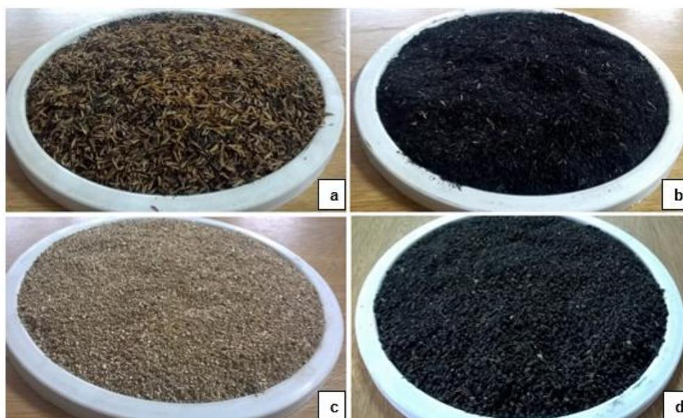
Figura 2 – Matérias-primas utilizadas em formulações de substratos: Casca de arroz carbonizada (a); cinza de casca de arroz (b); vermiculita (c); lodo de esgoto (d).
