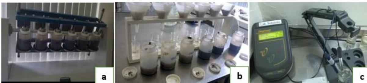
Figura 7 - Agitador tipo Wagner com amostras em recipientes (a), amostras sendo filtradas em funis com o descarte de 10 ml ao fundo (b), equipamento de leitura de CE (c).
