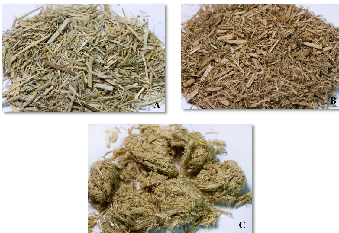
Figura 25. Biomassa sem pré-tratamento (A), biomassa após tratamento ácido (B) e biomassa após tratamento ácido seguido de alcalino (C).
