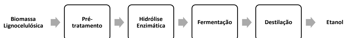
Figura 8. Principais etapas do processo de produção de etanol de segunda geração.
