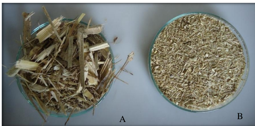
Figura 15. Biomassa de arundo coletada no município de Pelotas/RS após secagem (A) e após moagem em moinho de facas (B).
