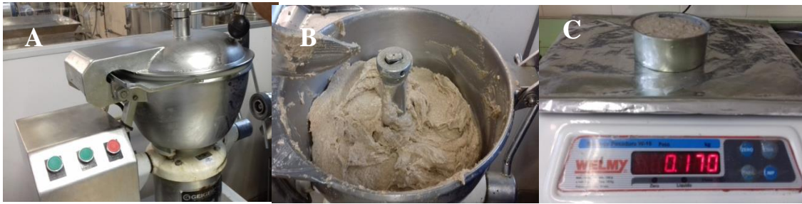
Figura 5. (A) Homogeneização dos ingredientes; (B) Massa do patê preparada para ser colocada nas latas; (C) Patê acondicionado na embalagem (lata).
