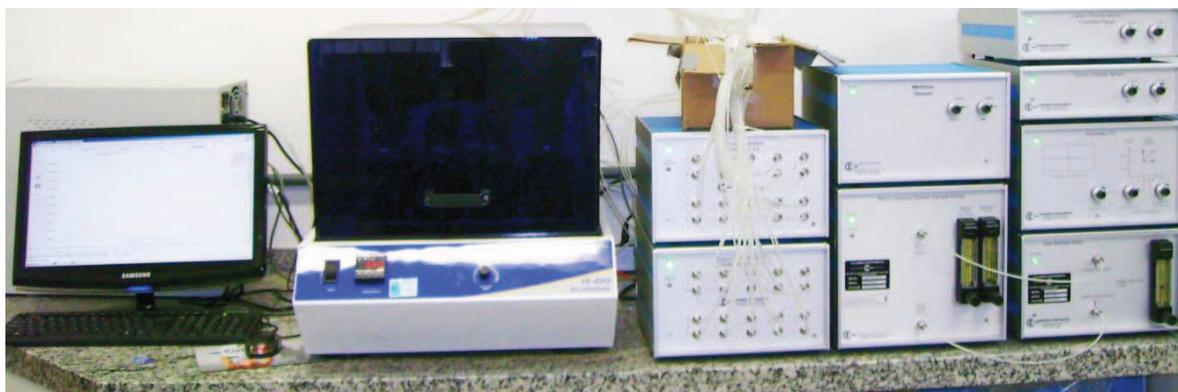
Figura 3.2. Respirômetro anaeróbico automático Micro-Oximax utilizado nos testes de atividade metanogênica específica (AME).
