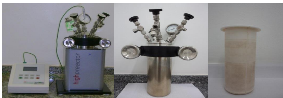
Figura 17: Mini-reator de alta pressão (Berghof modelo BR-300, 40 bar) utilizado no pré-tratamento termoquímico dos resíduos agroindustriais.
