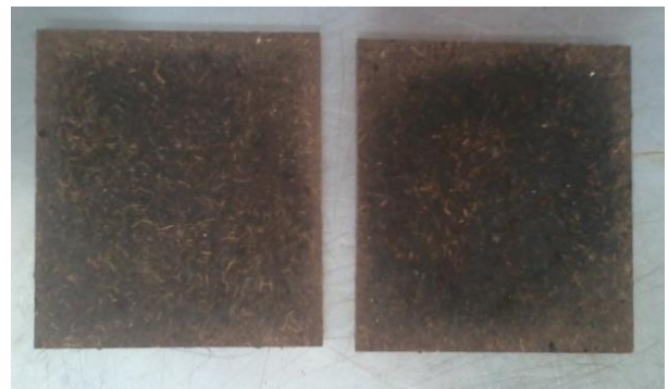
Figura 48 - Pannel de casca de coco verde (PCCV)
