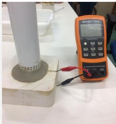
**Figura 10** Sensor capacitivo cilíndrico para determinação da propriedade dielétrica das sementes.
