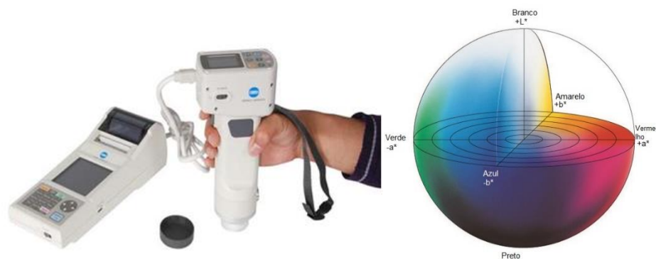
Figura 7. Colorímetro MINOLTA modelo CR300 (a) e sistema Lab de cores (b).
