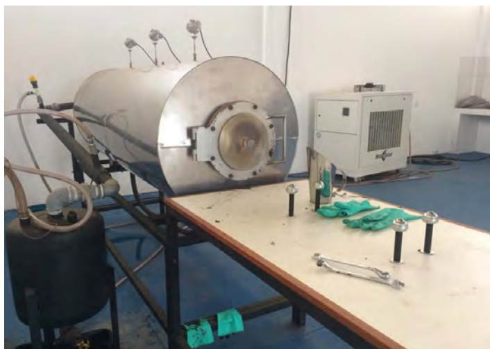
Figura 5. Reator de pirólise localizado na Embrapa Agrossilvipastoril.
