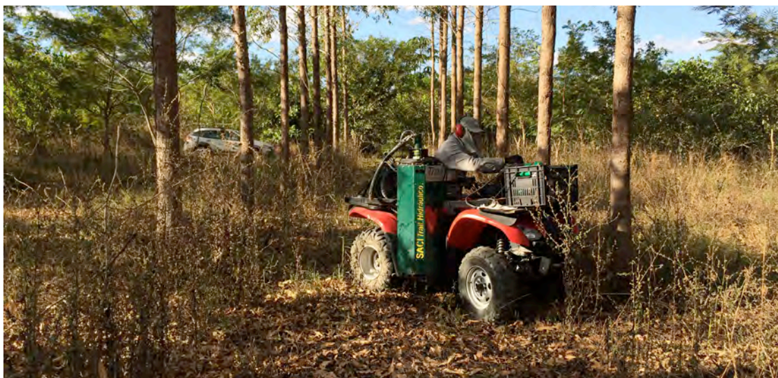
Figura 1. Coleta de amostras de solo utilizando amostrador automático no tratamento 1 do experimento de recomposição de Reserva Legal, Sinop, MT.
