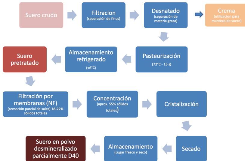
Figura 3.5 Diagrama de flujo para la obtención de suero en polvo desmineralizado D40 a partir de suero crudo.
