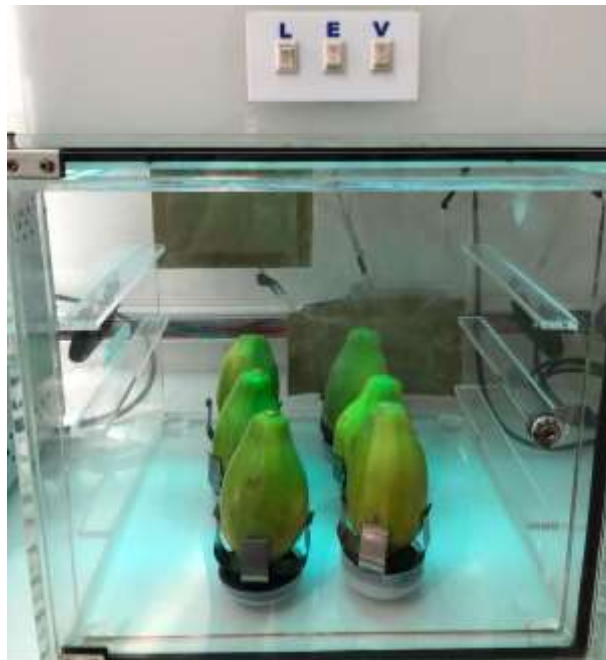
Figura 1. Mamões na câmara de irradiação da luz Ultravioleta C para o teste in vivo .
