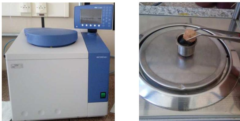
Figura 1 - Calorímetro e pastilhas de amostras de sorgo.
