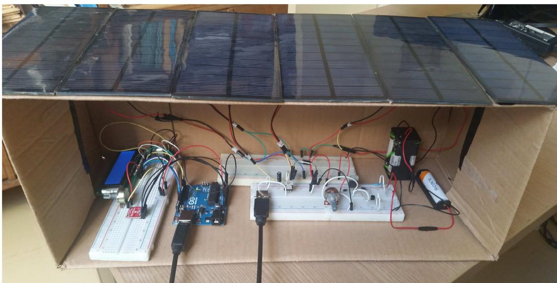
*Figura 2. Unidade com seis células solares ligadas ao circuito de alimentação do Arduino.*
