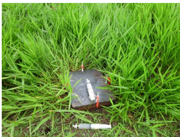
Figura 4. Detalhe da câmara estática fechada no momento da coleta do gás óxido nitroso numa área sob cobertura de pastagem de Brachiaria humidicola em Seropédica, RJ
