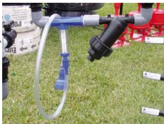
Figura 4. Injetor tipo Venturi utilizado em fertirrigação.
