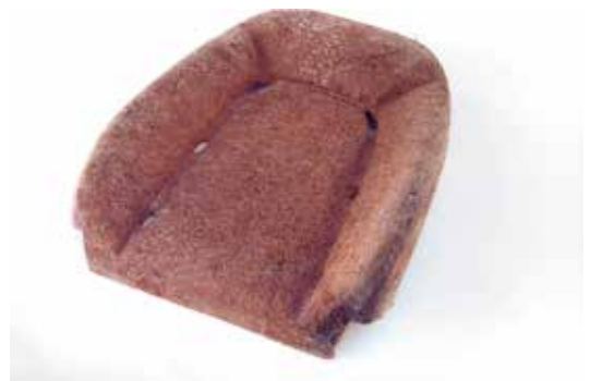
Figura 5. Estofamento de carro feito com fibra da casca de coco-seco.
