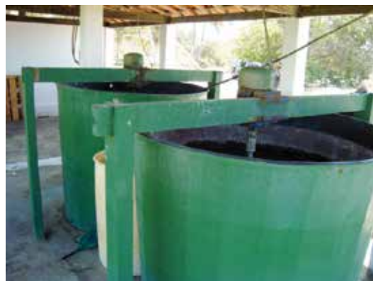
Figura 1. Tanques de solução fertilizante em fibra de vidro e com agitador mecânico.
