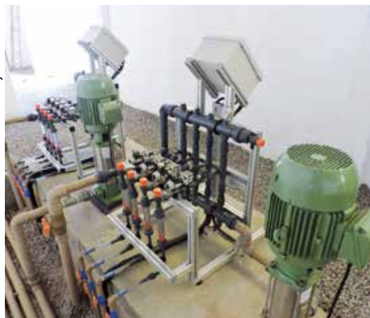
Figura 5. Sistema automatizado de injeção de fertilizantes com injetores tipo Venturi e bomba auxiliar.
