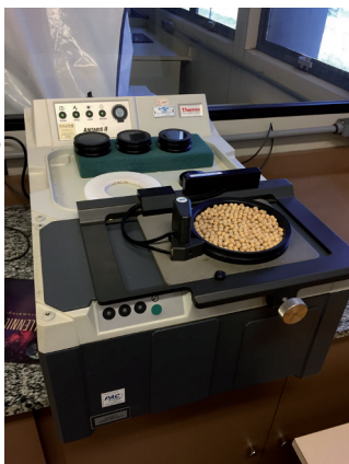
Figura 1. Equipamento NIR utilizado na Embrapa Soja desde 2010 e espectros originais de amostras de soja em grão coletados para a construção dos modelos de predição para teor de óleo e proteína.
