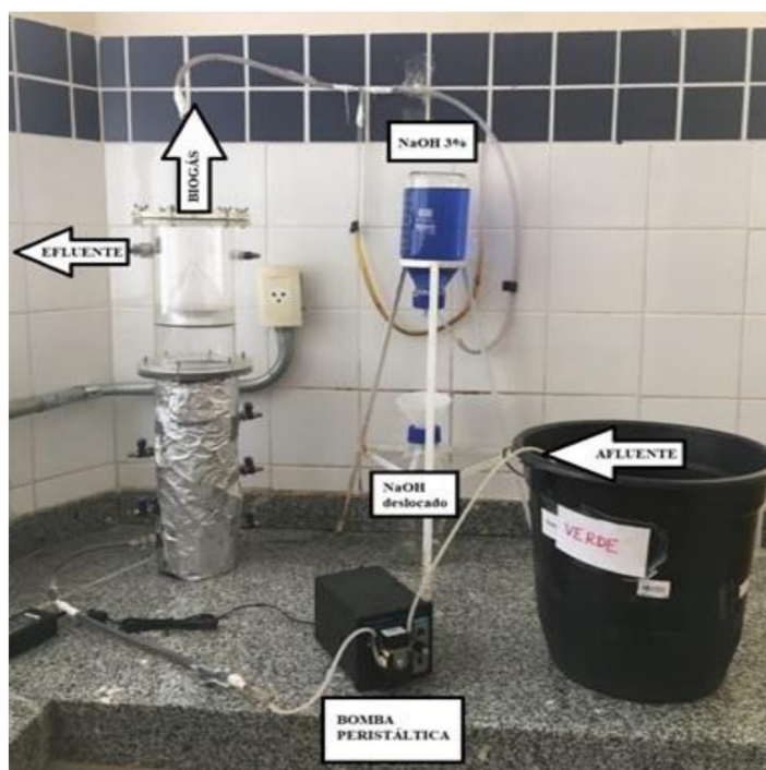
Figura 1: Representação esquemática do aparato experimental utilizado na pesquisa.
