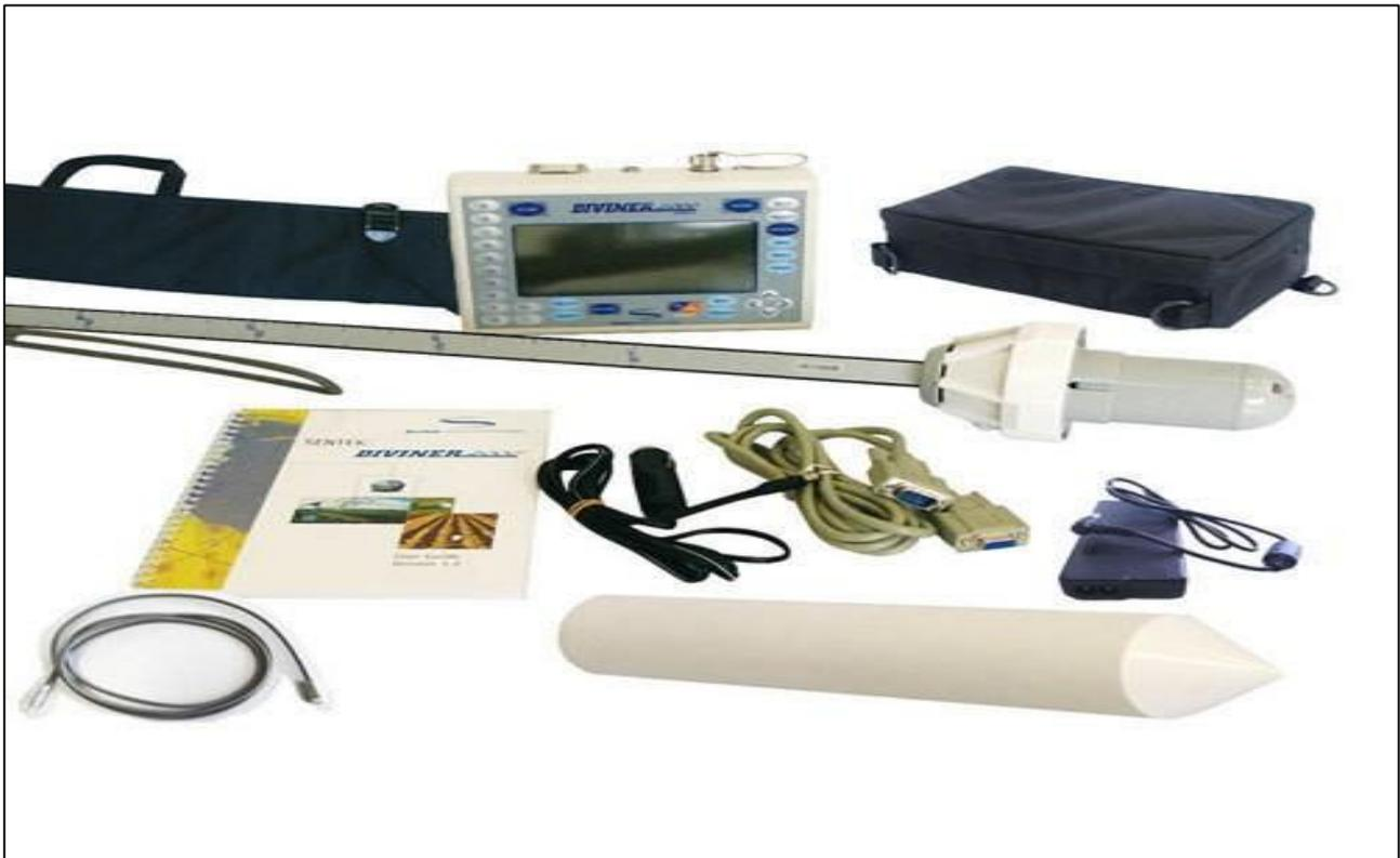
Figura 4 – Sonda Diviner 2000® e seus componentes. Fonte: Fondriest Environmental (2015)
