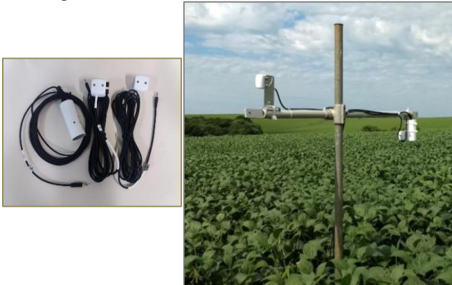
Figura 1. Detalhe do equipamento SRS NDVI Hemisférico e com Limitador de Visão instalado na lavoura experimental em Carazinho, RS, safra 2017/18.
